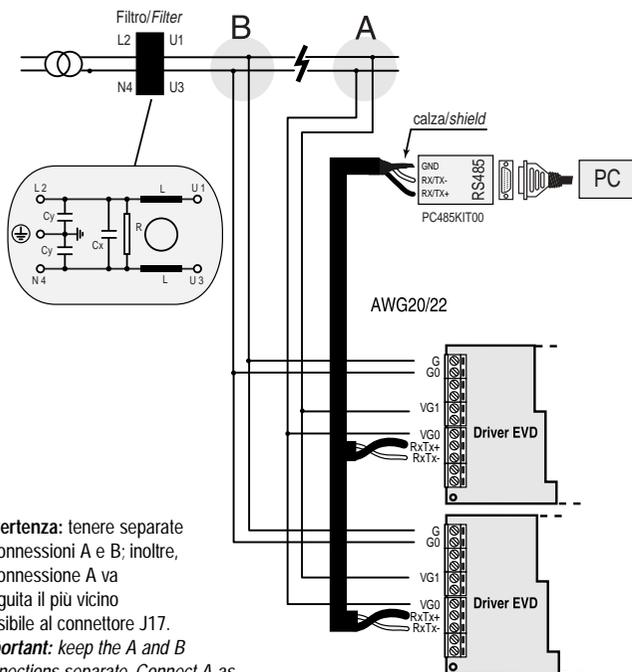
**Avvertenza:** tenere separate le connessioni A e B; inoltre, la connessione A va eseguita il più vicino possibile al connettore J17.
