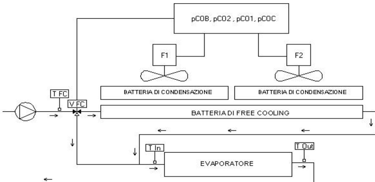
BATTERIA DI CONDENSAZIONE = CONDENSATION BATTERY
