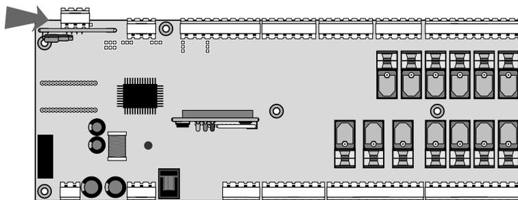
La connessione alla rete RS485 si ottiene tramite il connettore a morsetti estraibili presente sulla scheda. I significati dei pin su tale connettore sono evidenziati dalla serigrafia presenti sulla scheda. Essi sono:
